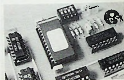
Afb. 9 Pagina 0 van de EPROM bevat de tabellen voor de 4-stapcyclus en pagina 1 voor de 8-stapcyclus. Deze tabellen zijn in te stellen met de DIP-schakelaar (lees de tekst).
